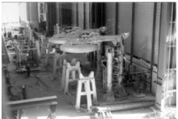
Fig. 5- Estación de secado y precalentamiento de cucharas.
